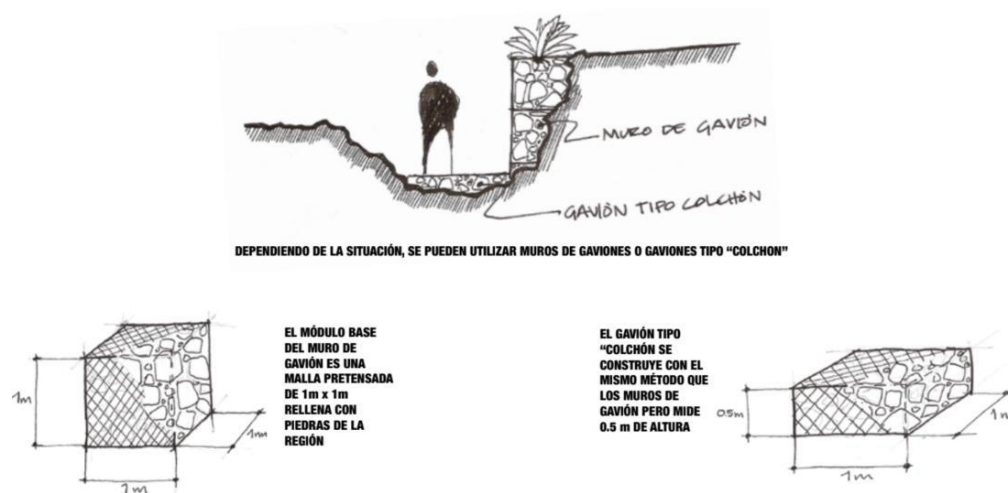
Figura 5.17. Esquema de adecuación de bordes irregulares en el sendero con muro de gaviones
